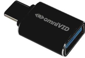
USB-C-Spannungsquellen verwenden üblicherweise das Power-Delivery-Protokoll, welches nicht mit den Komponenten Ihres omniVID® Solar Systems kompatibel ist. Durch die Verwendung des vorgenannten Kabels mit Adapter wird die Spannungsquelle in einen Kompatibilitätsmodus versetzt, welcher den Betrieb mit Ihrem omniVID® Solar Systems ermöglicht.
